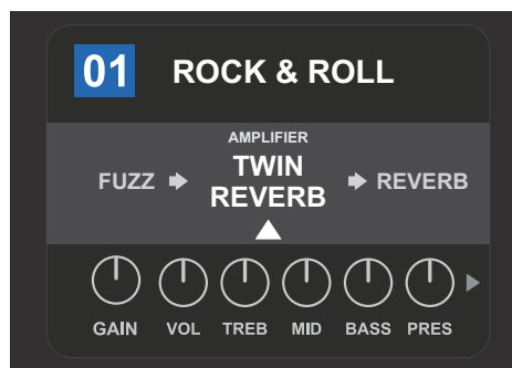
На слое SIGNAL PATH LAYER в данном пресете выбрана модель усилителя TWIN REVERB (стрелка под именем модели и слово "AMPLIFIER" над ним). По обе стороны усилителя расположены эффекты.
